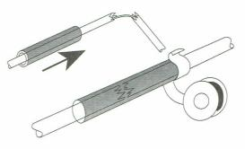
Sichern Sie die Hülse gegen Verrutschen mit Klebeband oder verpressen Sie sie z.B. mit einer Zange oder einem Stein.
